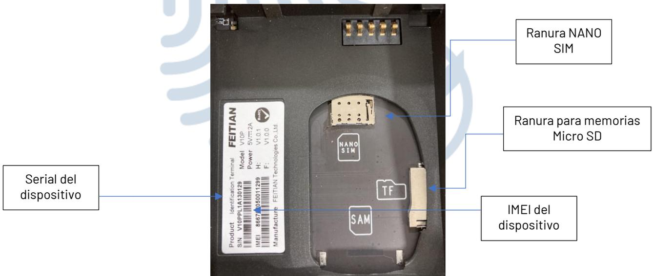
Figura 3 - Bio500 (disposición de ranuras)
